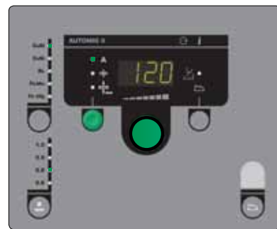
Контролният панел на Automig 2 с елементарно настройване на заваръчните параметри и МИГ брейзинг.
